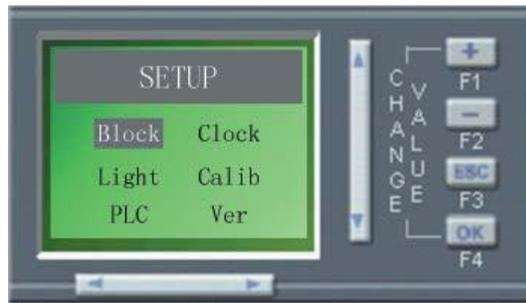
Na ovom interfejsu, pomerajte poziciju kursora pomoću  $\leftarrow \rightarrow \uparrow \downarrow$  tastera za izbor odgovarajućeg parametra postavki: parametar bloka (Block), parametar sata (Clock), PLC adresa (PLC), kalibracija (Calib) i broj verzije (Ver), i pritisnite "OK" taster za potvrdu. Kada pritisnete ESC vraćate se na glavni interfejs.
