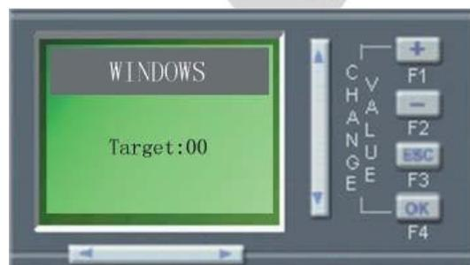
Na ovom interfejsu, kliknite na "OK" taster za unos (pomoću "+,-" tastera) specifikovanog broja ekrana na koji želite da pređete. Pritiskajte "+, -" tastere za izmenu broja na poziciji kursora, i pomoću tastera " ← → " pomerajte poziciju kursora. Pritisnite "OK" taster nakon izmene ciljanog broja. Ukoliko ne postoji korisnički definisani interfejs pod tim brojem, pojaviće se poruka "Error!" (Greška). Pritisnite ESC za povratak na glavni interfejs.
