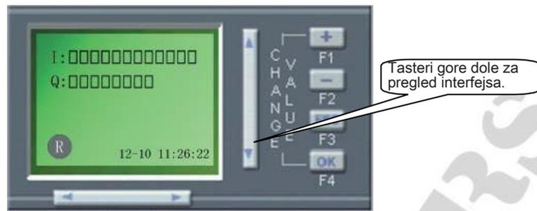
Na APB-HMI mogu biti prikazane trenutne vrednosti parametara različitih tajmera, brojača i analognih komparatora. Na ovom HMI su prikazana dva podatka: trenutna vrednost i vrednost parametra. Interfejs se može modifikovati, dodavati i brisati u skladu sa Vašim potrebama.
