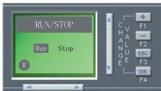
Na ovom interfejsu možete menjati poziciju kursora pomoću tastera " ← → ". Pomoću ovih tastera izaberite "Run" ili "Stop" i pritisnite "OK" taster za potvrdu. Pritisnite ESC za povratak na glavni ekran.
