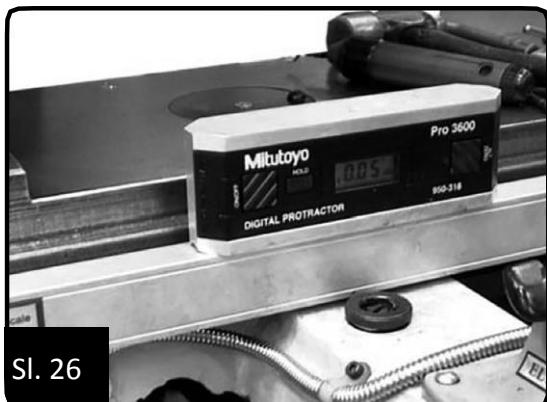
Kada montirate glavu čitača, ako je potrebno postavite zaptivke za glavu čitača (Sl.27) tako da se ona kreće zajedno i poravnato sa mernom letvom i radi izbegavanja oštećenja merne letve. Testiranje paralelnosti se može izvesti ili indikatorom sa kružnom skalom ili preciznom libelom (Sl.26). Mora se postaviti obloga (Sl. 28).
