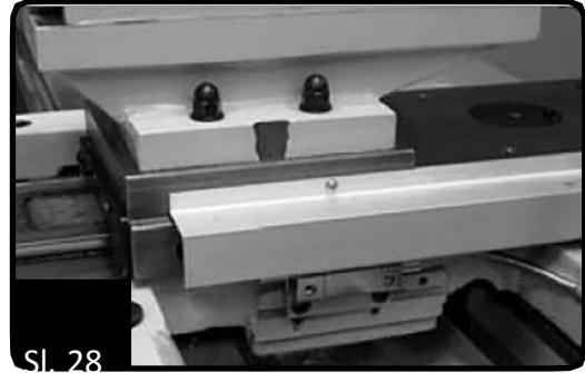
Longitudinalna (uzdužna) merna letva treba da se montira na zadnjem delu struga (Sl.29) sa otvorenom stranom letve na dole i paralelno sa ležajem (Sl.30). Glava čitača se montira na sedište (Sl.30) pomoću isporučenih nosača. Za neke strugove mogu biti potrebne određene modifikacije. Preko klizača treba montirati obloge (Sl.30).
