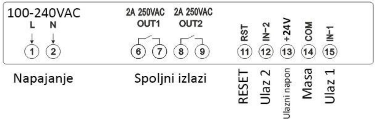
\* Instrument je opremljen NPN senzorom.
